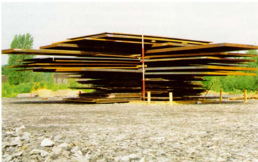
Simulation von Bauwerkslasten auf dem Testfeld
